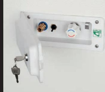
Ein Gasanschluss im Staufach ermöglicht es Ihnen, auf das Mitführen von Gasflaschen für den Grill zu verzichten - schließen Sie Ihren Grill einfach an den eigenen Gasvorrat des Wohnwagens an.
